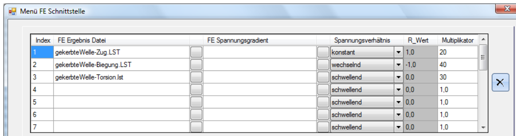
Eingabe der FE-Datei mit Belastungsart und Multiplikator
